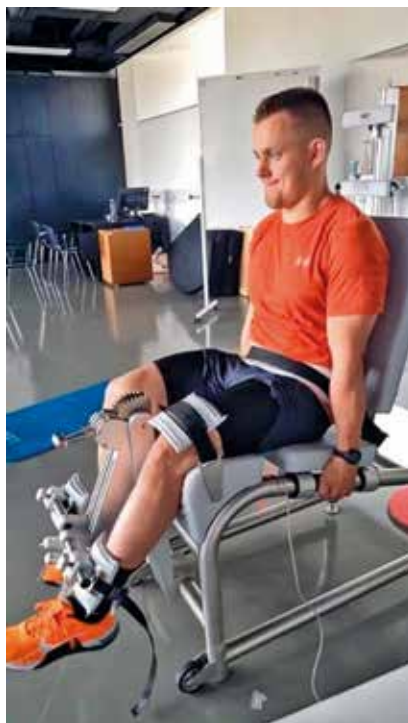
Slika 2. Prikaz postavitve preiskovanca ter naprave med izvajanjem meritev jakosti upogibalk in iztegovalk kolena
